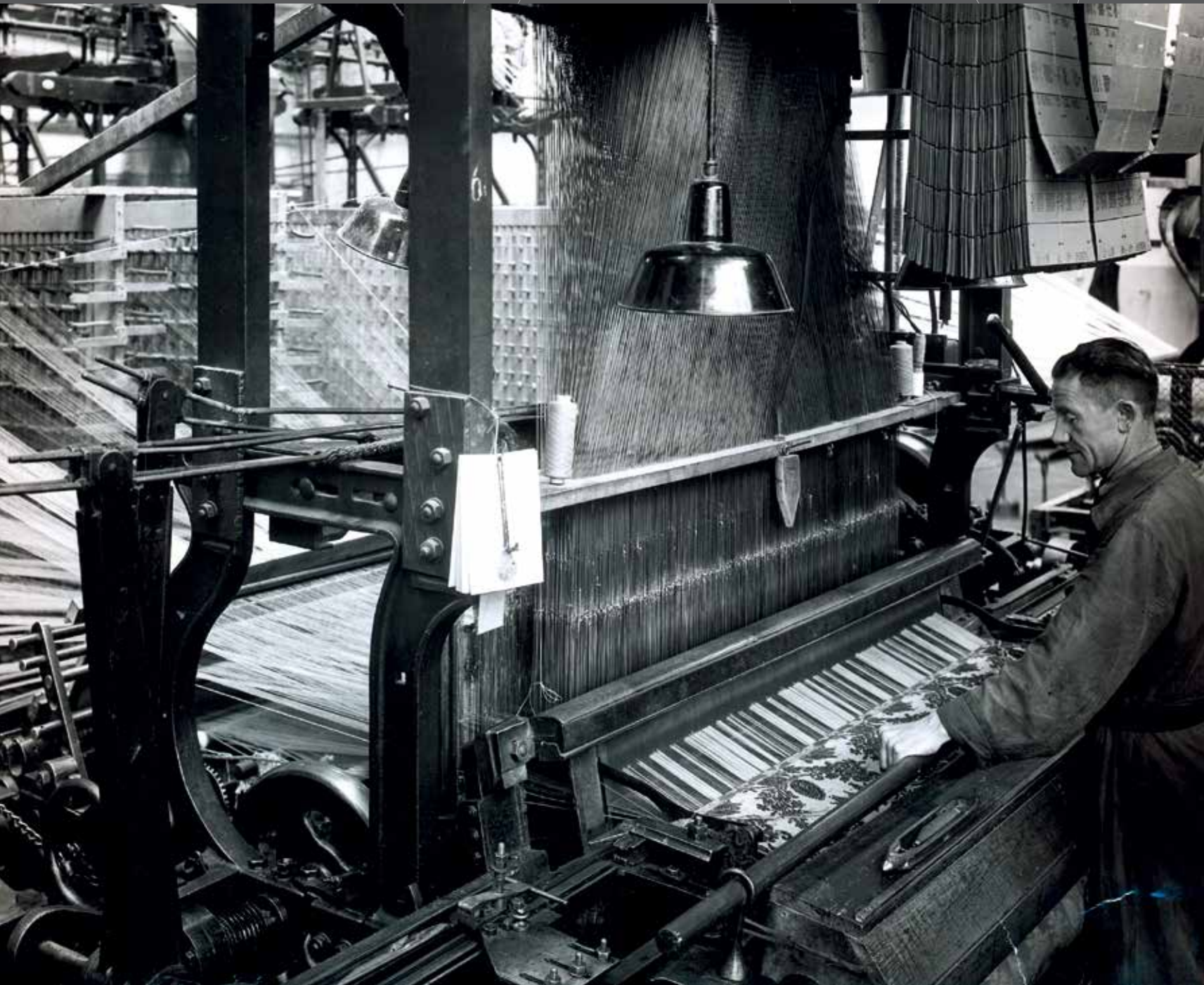
Het weven van gedessineerde stoffen op het Jaquard weefgetouw, rechtsboven zijn de ponskaarten zichtbaar.
